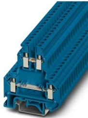
Doppelstockklemme, Nennspannung: 500 V, Nennstrom: 32 A, Anschlussart: Schraubanschluss, 1. und 2. Etage, Bemessungsquerschnitt: 4 mm<sup>2</sup>, Querschnitt: 0,2 mm<sup>2</sup> - 4 mm<sup>2</sup>, Montageart: NS 35/7,5, NS 35/15, NS 32, Farbe: blau
