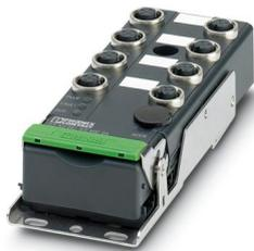
AS-i-Digital Ein-/ Ausgabemodul, AB-Slave, 4 digitale Eingänge, 24 V DC, 2-, 3- und 4-Leiter-Anschlussstechnik, 4 digitale Ausgänge, 24 V DC Schutzart IP67
