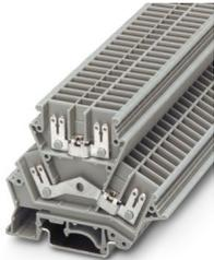
Durchgangsklemme, Nennspannung: 400 V, Nennstrom: 20 A, Anschlussart: Flachsteckanschluss, 1. und 2. Etage, Bemessungsquerschnitt: 4 mm<sup>2</sup>, Querschnitt: 0,5 mm<sup>2</sup> - 6 mm<sup>2</sup>, Montageart: NS 35/7,5, NS 35/15, NS 32, Farbe: grau
