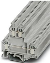
Doppelstockklemme, Nennspannung: 500 V, Nennstrom: 24 A, Anschlussart: Schraubanschluss, 1. und 2. Etage, Bemessungsquerschnitt: 2,5 mm<sup>2</sup>, Querschnitt: 0,2 mm<sup>2</sup> - 4 mm<sup>2</sup>, Montageart: NS 35/7,5, NS 35/15, NS 32, Farbe: grau
