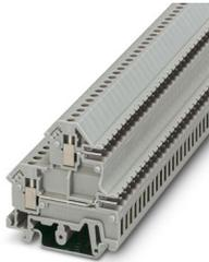
Doppelstockklemme, Strom und Spannung werden durch den eingesetzten Stecker bestimmt., Nennspannung: 250 V, Nennstrom: 10 A, Anschlussart: Schraub- / Steckanschluss, 1. und 2. Etage Anschluss links, Querschnitt: 0,2 mm<sup>2</sup> - 4 mm<sup>2</sup>, Montageart: NS 35/7,5, NS 35/15, NS 32, Farbe: grau
