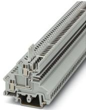
Doppelstockklemme, Nennspannung: 250 V, Nennstrom: 12 A, Anzahl der Anschlüsse: 4, Polzahl: 1, Anschlussart: Schraub- / Steckanschluss, 1. und 2. Etage Anschluss links, Querschnitt: 0,2 mm<sup>2</sup> - 4 mm<sup>2</sup>, Montageart: NS 35/7,5, NS 35/15, NS 32, Farbe: grau
