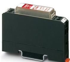
Tragschienenmodul mit Überspannungsfeinschutz, Montage auf NS 35/7,5. Nennspannung: 24 V DC, Gehäusebreite: 12,5 mm
