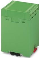
Einbaugehäuse, Gehäuseunterteil, mit Schnappfuß, ohne Lüftungsschlitze, Breite: 67,5 mm, Höhe: 75 mm, Farbe: grün (ähnlich RAL 6021), Querverbindung: ohne Busverbinder, Polzahl Querverbinder: nicht relevant
