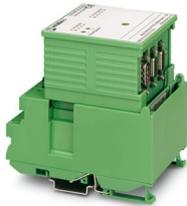
INTERBUS-ST-Busklemme, 24 V DC, 9-polig, D-SUB mit zusätzlichem Fernbus-Stich, 9-polig D-SUB, Schutzart IP20, bestehend aus: Klemmenteil mit Zugfederanschluss und Modulelektronik
