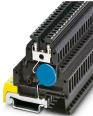
Reihenklemme mit Entstörkondensator zwischen Klemmkörper und Tragschiene, separater PE-Anschluss, Kapazität: 12 nF, Montage auf NS 35/7,5, Klemmenbreite: 6,2 mm, Klemmenhöhe: 69 mm
