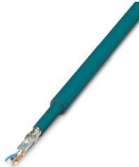
CAT5-SF/UTP-Kabel (J-02YS(ST)C HP 2 x 2 x 24 AWG), schweres Installationskabel, 2 x 2 x 0,22 mm<sup>2</sup>, Massivleiter, geschirmt, Außenmantel: 7,8 mm Durchmesser, Innenmantel: 5,75 mm ± 0,15 mm Durchmesser
