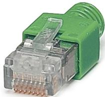
RJ45-Steckverbinder, Bauform: RJ45, Schutzart: IP20, Polzahl: 8, 1 GBit/s, CAT5 (IEC 11801:2002), Material: Kunststoff, Anschlussart: Crimpanschluss, Anschlussquerschnitt: AWG 26- 24, Kabelabgang: gerade, Farbe: grün, Ethernet
