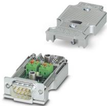
D-SUB-Stecker, 9-polig, Stift, axiale Ausführung mit zwei Kabelzuführungen, Bussystem: PROFIBUS DP bis 12 MBit/s, Abschlusswiderstand über Schiebeschalter zuschaltbar, Pinbelegung: 3, 5, 6, 8; Federkraftanschlussklemmen
