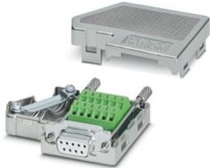
D-SUB-Stecker, 9-polige Buchse, zwei Kabelzuführungen unter 35°, Bussystem: MODBUS, BODBUS-PLUS, BITBUS, ARCNET, MULT/MININET(B&R), SYSTEM 2003(B&R), P-NET, Pinbelegung: 1, 2, 3, 5, 6, 8; Schraubanschlussklemmen
