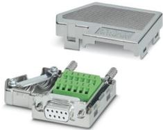
D-SUB-Stecker, 9-polige Buchse, zwei Kabelzuführungen unter 35°, Bussystem: CAN, KEBA bis 1 MBit/s, Pinbelegung: 2, 3, 4, 5, 6, 7; Schraubanschlussklemmen
