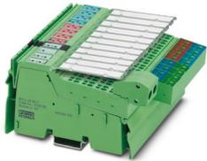
Inline, Buskoppler, INTERBUS, Inline-Schirmstecker, Digitale Eingänge: 16, 24 V DC, Anschlusstechnik: 3-Leiter, Digitale Ausgänge: 16, 24 V DC, 500 mA, Anschlusstechnik: 3-Leiter, Übertragungsgeschwindigkeit im Lokalbus: 500 kBit/s, Schutzart: IP20, inklusive Inline-Steckern und Beschriftungsfeldern
