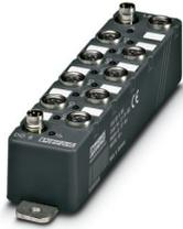
Das platzsparende Lokalbus-Gerät ist für den Einsatz in unmittelbarer Nähe zum Prozess besonders geeignet. Funktionen: 8 digitale Ausgänge je mit 500 mA belastbar, kanalgenaue Diagnose, Kurzschluss- und Überlastschutz, M8-Anschlussstechnik
