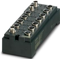
Das Lokalbus-Gerät hat digitale Ein- und Ausgänge. Funktionen: 16 digitale Eingänge, 3 ms Filterzeit, 16 digitale Ausgänge je 500 mA, 500 KBd / 2 MBd umschaltbar, Diagnosestrategie, Kurzschluss-/Überlastschutz, M12-Schnellanschlusstechnik 8-polig
