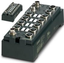
Das Lokalbus-Gerät hat digitale Ausgänge. Funktionen: 8 digitale Ausgänge je 500 mA, 500 KBd / 2 MBd umschaltbar, kanalgenaue Diagnose, Kurzschluss- und Überlastschutz, M12-Schnellanschlusstechnik
