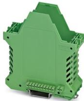
Tragschienengehäuse, Gehäuseunterteil mit Metallfußriegel, mit 2 FE-Kontakten, hohe Bauform, mit Lüftungsschlitzen, Breite: 35,2 mm, Höhe: 99 mm, Tiefe: 107,3 mm, Farbe: grün (ähnlich RAL 6021), Querverbindung: integrierter Busverbinder, Polzahl Querverbinder: 10+2, Busverbinder: 10 parallele Kontakte, 2 serielle Kontakte
