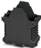
Tragschienengehäuse, Gehäuseunterteil mit Metallfußriegel, hohe Bauform, mit Lüftungsschlitzen, Breite: 45,2 mm, Höhe: 99 mm, Tiefe: 107,3 mm, Farbe: schwarz (ähnlich RAL 9005), Querverbindung: ohne Busverbinder, Polzahl Querverbinder: nicht relevant
