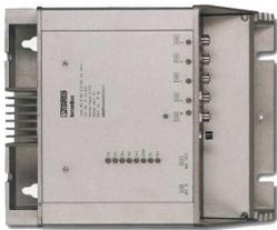
Drive Shuttle, INTERBUS-Motorschalter für Wendelastbetrieb mit Sanftanlauf, 4 digitale Eingänge, 24 V DC, Schutzart IP54
