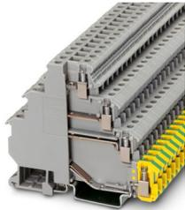
Motoranschlussklemme, Nennspannung: 400 V, Nennstrom: 24 A, Anschlussart: Schraubanschluss, 2., 3., und 4. Etage, Bemessungsquerschnitt: 2,5 mm<sup>2</sup>, Querschnitt: 0,2 mm<sup>2</sup> - 4 mm<sup>2</sup>, Montageart: NS 35/7,5, NS 35/15, Farbe: grau
