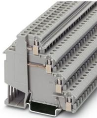
Initiatoren-/Aktorenklemme, Nennspannung: 250 V, Nennstrom: 24 A, Anschlussart: Schraubanschluss, 3. und 4. Etage, Bemessungsquerschnitt: 2,5 mm<sup>2</sup>, Querschnitt: 0,2 mm<sup>2</sup> - 4 mm<sup>2</sup>, Montageart: NS 35/7,5, NS 35/15, Farbe: grau
