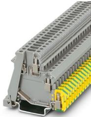
Initiatoren-/Aktorenklemme, Strom und Spannung werden durch den eingesetzten Stecker bestimmt., Nennspannung: 250 V, Nennstrom: 16 A, Anschlussart: Schraubanschluss, Bemessungsquerschnitt: 1,5 mm<sup>2</sup>, Querschnitt: 0,2 mm<sup>2</sup> - 4 mm<sup>2</sup>, Montageart: NS 35/7,5, NS 35/15, Farbe: grau
