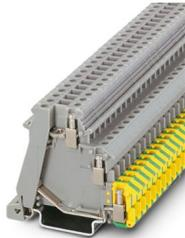
Initiatoren-/Aktorenklemme, Nennspannung: 250 V, Nennstrom: 24 A, Anschlussart: Schraubanschluss, Bemessungsquerschnitt: 2,5 mm<sup>2</sup>, Querschnitt: 0,2 mm<sup>2</sup> - 4 mm<sup>2</sup>, Montageart: NS 35/7,5, NS 35/15, Farbe: grau
