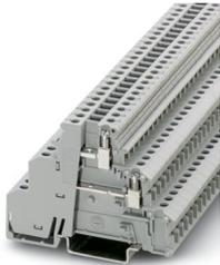
Initiatoren-/Aktorenklemme, Nennspannung: 250 V, Nennstrom: 24 A, Anschlussart: Schraubanschluss, 1. und 2. Etage, Bemessungsquerschnitt: 2,5 mm<sup>2</sup>, Querschnitt: 0,2 mm<sup>2</sup> - 4 mm<sup>2</sup>, Montageart: NS 35/7,5, NS 35/15, Farbe: grau
