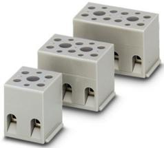
Geräteklemme, Nennspannung: 500 V, Nennstrom: 32 A, Anzahl der Anschlüsse: 6, Polzahl: 3, Anschlussart: Schraubanschluss, Bemessungsquerschnitt: 4 mm<sup>2</sup>, Querschnitt: 0,2 mm<sup>2</sup> - 4 mm<sup>2</sup>, Montageart: direktes Anschrauben, Farbe: grau
