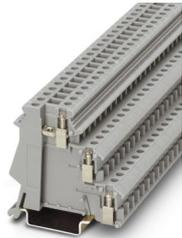
Initiatoren-/Aktorenklemme, Nennspannung: 250 V, Nennstrom: 24 A, Anschlussart: Schraubanschluss, 1., 2. und 3. Etage, Bemessungsquerschnitt: 2,5 mm<sup>2</sup>, Querschnitt: 0,2 mm<sup>2</sup> - 4 mm<sup>2</sup>, Montageart: NS 35/7,5, NS 35/15, Farbe: grau
