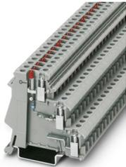
Initiatoren-/Aktorenklemme, Nennstrom: 24 A, Anschlussart: Schraubanschluss, Querschnitt: 0,2 mm<sup>2</sup> - 4 mm<sup>2</sup>, Montageart: NS 35/7,5, NS 35/15, Farbe: grau
