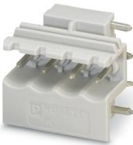
Leiterplatten-Grundleiste, Nennquerschnitt: 2,5 mm<sup>2</sup>, Farbe: lichtgrau, Nennstrom: 12 A, Bemessungsspannung (III/2): 320 V, Kontaktoberfläche: Sn, Kontaktart: Stift, Anzahl der Reihen: 1, Polzahl: 4, Artikelfamilie: MSTBO 2,5/..-G1R, Anschlussart: steckbar, Montage: Wellenlöten, Anzahl der Lötpins pro Potenzial: 1, Stecksystem: COMBICON MSTB 2,5, Ausrichtung Steckgesicht: Orthogonal, Verriegelung: ohne, Artikel mit seitlichem Pinabgang rechts
