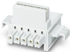
Tragschienen-Busverbinder, Farbe: lichtgrau, Nennstrom: 8 A (parallele Kontakte), Bemessungsspannung (III/2): 125 V, Polzahl: 5, Artikelfamilie: TBUS5-22,5..., Rastermaß: 3,81 mm, Montage: Tragschienenmontage, Verriegelung: ohne, Befestigungsart: ohne, Verpackungsart: verpackt im Karton, Artikel mit vergoldeten Kontakten, Busstecker zur Verbindung mit Elektronikgehäusen, 5 Parallelkontakte
