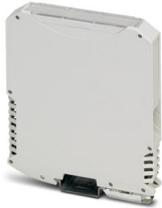
Tragschienengehäuse, Komplettgehäuse mit Metallfußriegel, hohe Bauform, mit Lüftungsschlitzen, Breite: 17,6 mm, Höhe: 99 mm, Tiefe: 113,65 mm, Farbe: lichtgrau (ähnlich RAL 7035), Querverbindung: Tragschienen-Busverbinder (optional), Polzahl Querverbinder: 5
