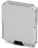
Tragschienengehäuse, Komplettgehäuse mit Metallfußriegel, hohe Bauform, ohne Lüftungsschlitze, Breite: 22,6 mm, Höhe: 99 mm, Tiefe: 113,65 mm, Farbe: lichtgrau (ähnlich RAL 7035), Querverbindung: Tragschienen-Busverbinder (optional), Polzahl Querverbinder: 5
