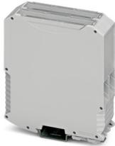
Tragschienengehäuse, Komplettgehäuse mit Metallfußriegel, hohe Bauform, ohne Lüftungsschlitze, Breite: 35,2 mm, Höhe: 99 mm, Tiefe: 113,65 mm, Farbe: lichtgrau (ähnlich RAL 7035), Querverbindung: Tragschienen-Busverbinder (optional), Polzahl Querverbinder: 5
