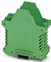
Tragschienengehäuse, Gehäuseunterteil mit Metallfußriegel, mit 2 FE-Kontakten, hohe Bauform, mit Lüftungsschlitzen, Breite: 45,2 mm, Höhe: 99 mm, Tiefe: 107,3 mm, Farbe: grün (ähnlich RAL 6021), Querverbindung: integrierter Busverbinder, Polzahl Querverbinder: 10, Busverbinder: 10 Parallelkontakte
