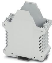
Tragschienengehäuse, Gehäuseunterteil mit Metallfußriegel, hohe Bauform, mit Lüftungsschlitzen, Breite: 45,2 mm, Höhe: 99 mm, Tiefe: 107,3 mm, Farbe: lichtgrau (ähnlich RAL 7035), Querverbindung: ohne Busverbinder, Polzahl Querverbinder: nicht relevant
