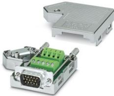
D-SUB-Stecker, 15-polig HD (High Density), Stift, ein 35°-Kabelabgang, Universaltyp für alle Systeme, Pinbelegung: 1, 2, 3, 6, 7, 8, 10, 13, 14 auf Schraubanschlussklemme
