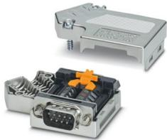
D-SUB-Stecker, 9-polig, Stift, 35°-Kabelabgang, Bussystem: PROFIBUS DP bis 12 MBit/s mit PG-D-SUB-Buchse zum Anschluss eines Programmiergeräts, Abschlusswiderstand über Schiebeschalter zuschaltbar, Pinbelegung: 3, 5, 6, 8; Schraubanschlussklemmen
