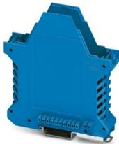
Tragschienengehäuse, Gehäuseunterteil mit Metallfußriegel, mit FE-Kontakt, hohe Bauform, mit Lüftungsschlitzen, Breite: 22,6 mm, Höhe: 99 mm, Tiefe: 107,3 mm, Farbe: blau (ähnlich RAL 5015), Querverbindung: integrierter Busverbinder, Polzahl Querverbinder: 10+2, Busverbinder: 10 parallele Kontakte, 2 serielle Kontakte
