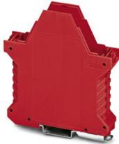
Tragschienengehäuse, Gehäuseunterteil mit Metallfußriegel, hohe Bauform, ohne Lüftungsschlitze, Breite: 22,6 mm, Höhe: 99 mm, Tiefe: 107,3 mm, Farbe: rot (ähnlich RAL 3001), Querverbindung: ohne Busverbinder, Polzahl Querverbinder: nicht relevant
