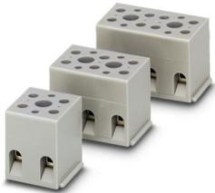
Geräteklemme, Nennspannung: 275 V, Nennstrom: 30 A, Anzahl der Anschlüsse: 6, Polzahl: 3, Anschlussart: Schraubanschluss, Bemessungsquerschnitt: 4 mm<sup>2</sup>, Querschnitt: 0,2 mm<sup>2</sup> - 4 mm<sup>2</sup>, Montageart: direktes Anschrauben, Farbe: grau
