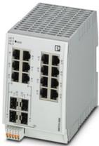
Managed Switch 2000 Serie, 12 RJ45-Ports 10/100/1000 MBit/s, 2 SFP-Ports 100/1000 MBit/s, 2 Combo-Ports, Schutzart: IP20, Umgebungstemperatur (Betrieb): -40 °C ... 70 °C, Versorgungsspannungsbereich: 12 V DC ... 57 V DC, PROFINET Conformance-Class B, Erweiterter Temperaturbereich, Entwicklungsprozess zertifiziert nach IEC 62443-4-1, Kompatibel zu IEC 62443-4-2
