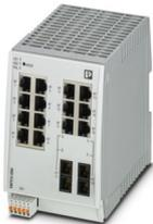
Managed Switch 2000 Serie, 14 RJ45-Ports 10/100 MBit/s, 2 SC-Multimode 100 MBit/s, Schutzart: IP20, Umgebungstemperatur (Betrieb): -40 °C ... 70 °C, Versorgungsspannungsbereich: 12 V DC ... 57 V DC, PROFINET Conformance-Class B, Erweiterter Temperaturbereich, Entwicklungsprozess zertifiziert nach IEC 62443-4-1, Kompatibel zu IEC 62443-4-2
