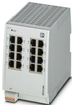
Managed Switch 2000 Serie, 16 RJ45-Ports 10/100 MBit/s, Schutzart: IP20, Umgebungstemperatur (Betrieb): 0 °C ... 60 °C, Versorgungsspannungsbereich: 18 V DC ... 32 V DC, PROFINET Conformance-Class A, Entwicklungsprozess zertifiziert nach IEC 62443-4-1, Kompatibel zu IEC 62443-4-2
