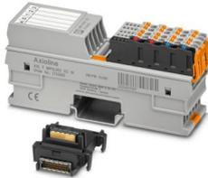
Axioline F XC, Funktionsmodul, 2 digitale Impulsschnittstellen zur Auswertung magnetostruktiver Wegaufnehmer mit Start/Stop-Schnittstelle, Übertragungsgeschwindigkeit im Lokalbus: 100 MBit/s, Schutzart: IP20, inklusive Bussockelmodul und Axioline F-Steckern
