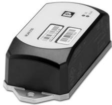
WLAN Access Point, Client für USA und Kanada, mit 2 internen Antennen zur Einlochmontage, IP66/68, WLAN 802.11 a, b, g, n, Frequenz: 2,4 GHz, 5 GHz, Anschlüsse: COMBICON 9 ... 32 V DC, RJ45: für LAN, Web, http/https, CLI
