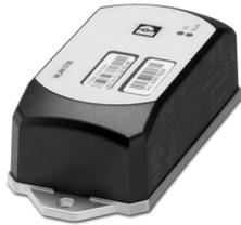
WLAN Access Point, Client mit zwei internen Antennen (MIMO) zur Einlochmontage, IP66/68, WLAN 802.11 a, b, g, n, Frequenz: 2,4 GHz, 5 GHz (inkl. DFS-Kanäle), Anschlüsse: COMBICON 9 ... 32 V DC, RJ45: für LAN, Web, http/https, CLI
