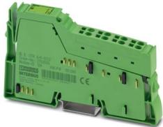
Inline, Temperaturerfassungsklemme, Analoge UTH-Eingänge: 4 (Typ K), Anschlusstechnik: 2-Leiter, Übertragungsgeschwindigkeit im Lokalbus: 500 kBit/s, Schutzart: IP20, inklusive Inline-Stecker
