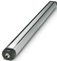
LED-Maschinenleuchte, 24 V DC, Abstrahlwinkel (vertikal/horizontal): 75 °/95 °, Länge: 1070 mm, Durchmesser: 70 mm, Schutzart: IP67, schwenkbar, resistent gegen Kühl- und Schmiermittel
